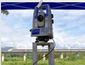
高铁桥梁监测
